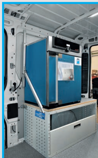
Un laboratorio móvil equipado con aire comprimido, corriente eléctrica y varios equipos del cliente montados por el personal Syncro System.
