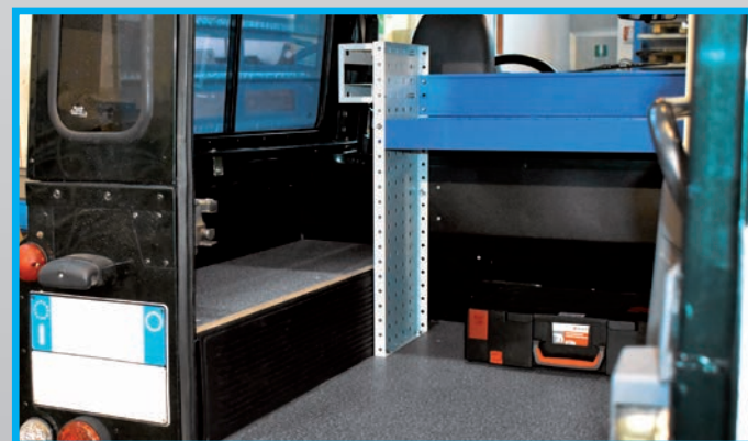
Equipamiento interno con estanterías y cajoneras montado en Land Rover Defender.
