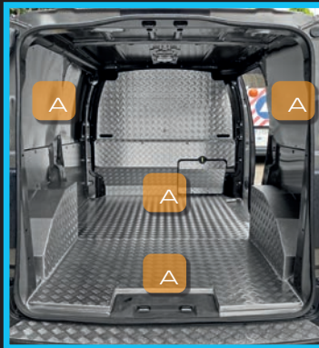
A van interior lined entirely in aluminium tread plate Ejemplo de revestimiento interno totalmente en aluminio
